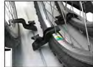
Befestigung der Räder mit Felgenspanner im Schraubkanal der Mot-wanne und des Auffahrprofils
