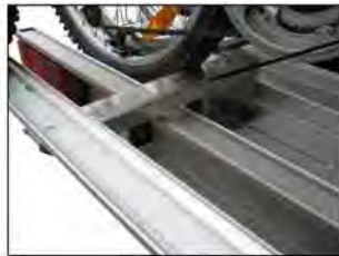
Zusätzliche Fahrradschiene mit dem Erweiterungsprofil im mittleren Schraubkanal der Motorradwanne fixieren und mit Skt-Schrauben M8x20 + U-Scheiben + Muttern sichern.
