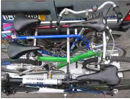
Zusätzliche Fahrradschiene mit dem Erweiterungsprofil im mittleren Schraubkanal der Motorradwanne fixieren und mit Skt-Schrauben M8x20 + U-Scheiben + Muttern sichern.
