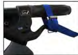
Handbremsen anziehen und mit kleinen Gurten festziehen.
